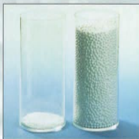
Uiterst kleine polystyreenbolletjes expanderen tot de bekende EPS-parels
